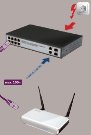
DN-95202 PoE Splitter Güçün Taşındığı Hedef Cihaz (Powered Device)
