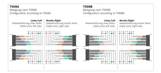
Pressen Sie die Adern mithilfe eines Anlegewerkzeugs (DN-LSA-PT) in die Schneidklemme und schneiden Sie die überschüssigen Kabelenden ab.
