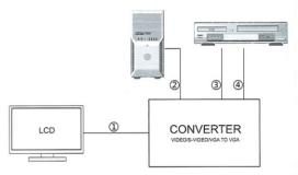
① VGA OUTPUT ② VGA INPUT ③ S-VIDEO INPUT ④ VIDEO INPUT
