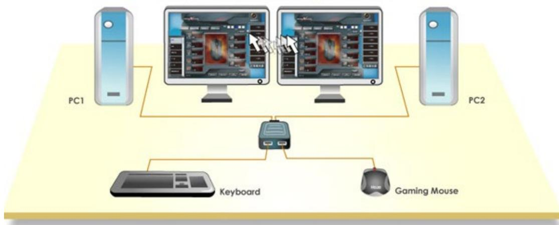
El conmutador KM permite una configuración compatible entre ordenadores de sobremesa o portátiles con diferentes plataformas de sistemas operativos. También se puede utilizar con los Tablet PC de Windows.
