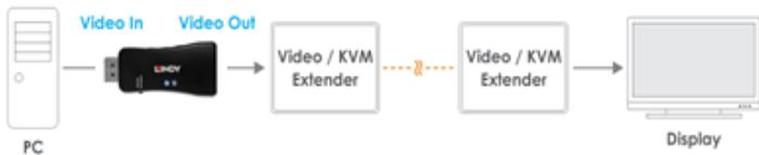
Beispiel für die Installation mit einem KVM Switch:
