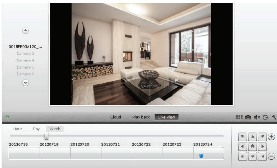
Falls die ausgewählte IP-Kamera die PTZ-Funktion unterstützt, kann das PTZ-Bedienfeld angeklickt werden, mit dem Sie die Kamera steuern. Andernfalls wird das Feld grau dargestellt, um anzuzeigen, dass es keine Funktion hat. Jede Bewegungseinstellung erfordert ein Anklicken.
