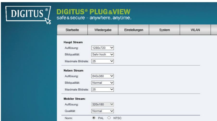
Sie können zwischen 5 Stufen der Bildqualitätseinstellung wählen, von „sehr hoch“ bis „sehr niedrig“. Von der Kamera werden drei Videostreams unterstützt. Der „Haupt Stream“, der für die lokale Darstellung und Aufzeichnung verwendet werden kann, der „Neben Stream“, der für den Fernzugriff bei eingeschränkter Internetverbindung genutzt werden kann und der „Mobile Stream“ der für die mobile Betrachtung optimiert ist.
