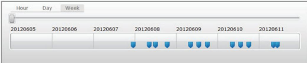
Die Details der aufgezeichneten Clips werden angezeigt, wenn sich die Maus über einem blauen Kennzeichen befindet und dieses die Farbe auf Orange wechselt. Sie können zum Überprüfen einen bestimmten Clip wählen.
