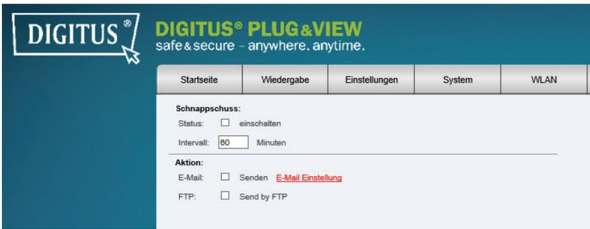
Es können automatisch Bilder in einem voreingestelltem Intervall ausgelöst werden. Hierzu aktivieren Sie bitte die automatische Aufnahme und legen fest, welche Aktion ausgeführt werden soll. Als Aktion steht Ihnen das Senden einer E-Mail, oder die Übertragung auf einen FTP-Server zur Verfügung.
