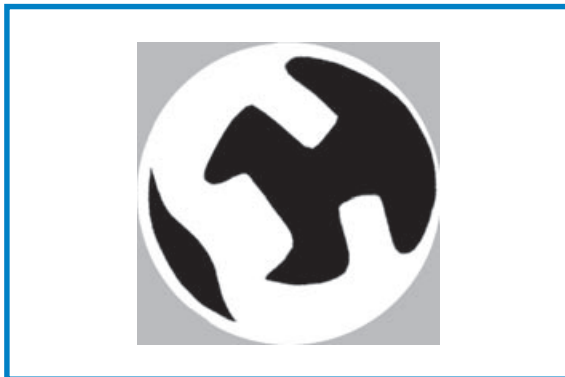
Querschnitt einer bestückten Leiterplatte: Cross section of an assembled P.C.Board: Ø = 0.98 mm
